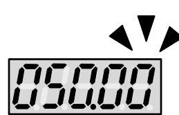
**При остановленном двигателе** на дисплее индицируется заданная частота,значащие разряды дисплея мигают. Нажатие в этот момент кнопок **ВВЕРХ** или **ВНИЗ** позволяет изменять значение заданной частоты. При этом мигает разряд индикатора, доступный для корректировки кнопками **ВВЕРХ** и **ВНИЗ**. Перемещение между разрядами обеспечивается кнопкой **ВВОД/ВЛЕВО**. Каждое нажатие этой кнопки приводит к перемещению мигающей цифры на один разряд влево.
