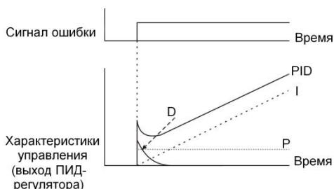
1. Пропорциональное управление (P). Управляющий сигнал пропорционален отклонению (сигналу ошибки). При P-управлении выход ПИД-регулятора не может быть равен нулю.
