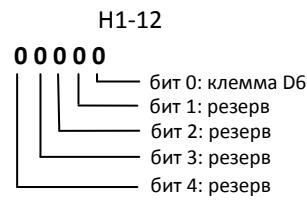
[бит = 0]: Функция активируется при замыкании клеммы (NO контакт).
