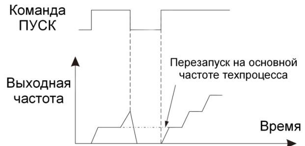
Настройка автоматического управления техпроцессом с использованием различных источников команды Пуск/Стоп:
