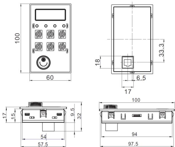
Разметка отверстия для монтажа
