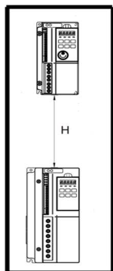
2.2.3. При размещении преобразователя частоты в шкафу необходимо обеспечить соблюдение температурного режима внутри шкафа с учетом собственного тепловыделения преобразователя.
